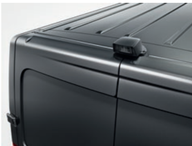
3 RÉTROVISION PERMANENTE avec caméra à l'arrière du pavillon pour voir comme dans un rétroviseur en phase de conduite.
