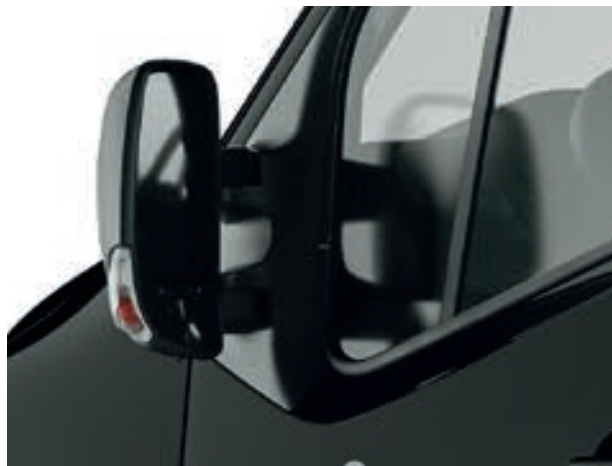
2 RÉTROVISEURS GRAND ANGLE à réglage électrique avec clignotants intégrés.
