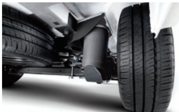
SUSPENSION PNEUMATIQUE* pour optimiser le confort et garder une assiette constante quel que soit le niveau de charge.
