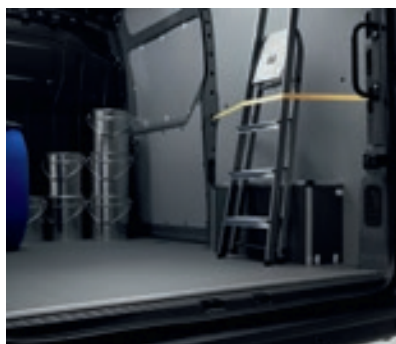
Parois latérales et plancher antidérapant polypropylène 6 mm
